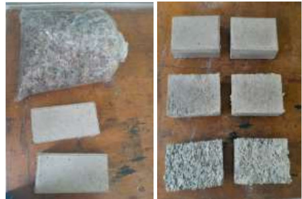
Gambar 2 dan 3. Contoh eco paving block dari percobaan awal hingga produk jadi siap pakai
