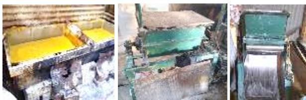
Gambar 2 Pemasakan adonan, mesin pengaduk dan pemipih adonan, kotor dan tidak higienis
