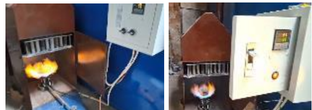
Gambar 9 Ujicoba TTG Oven Kerupuk
