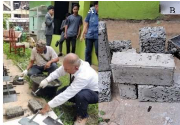
Gambar 6 (A). Pihak PkM dan masyarakat kelurahan Bencongan Indah Tangerang melakukan proses pembuatan eco-paving block bersama dan 6(B) Hasil akhir pembuatan eco-paving block .
