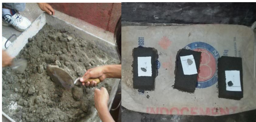
Gambar 2. Pencampuran Bahan Batako Dengan Komposisi Fly Ash Bervariasi
