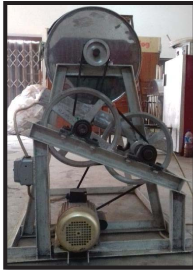
Gambar 2. Alat pencampur kedelai dan ragi tempe.
