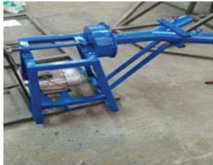
Gambar 1 Mesin penyedot debu dengan sudu sentripugal
