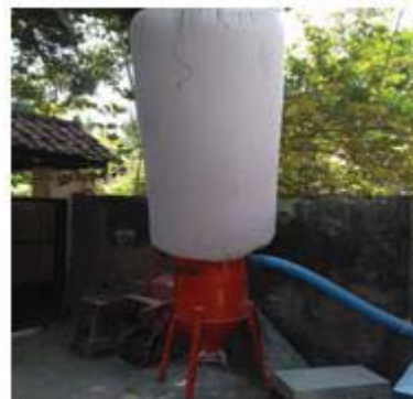
Gambar 4 Penampung debu yang sedang bekerja terhubung ke mesin penghisap debu
