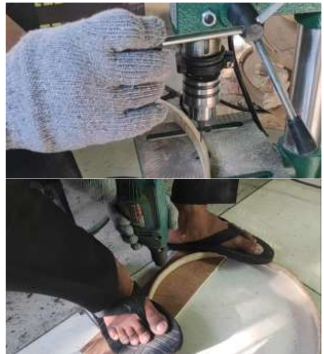
Gambar 7. Pelubangan papan ( tebok ) sebagai tatakan sangkar burung menggunakan mesin bor duduk (atas) dan bor tangan (bawah).
