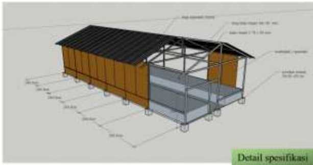
Gambar 10 Detail Spesifikasi Struktur Bangunan
