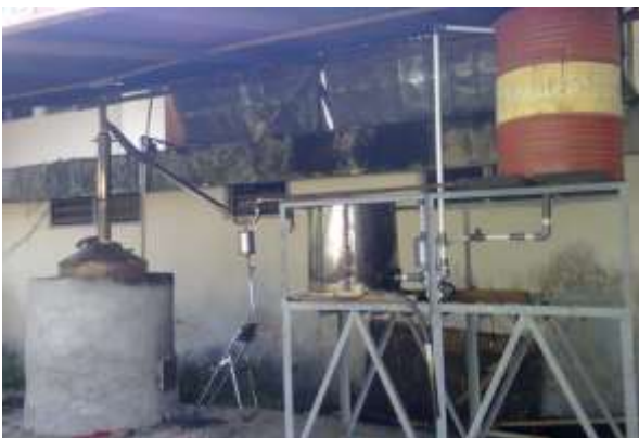
Gambar 1. Contoh sistem destilasi yang dibuat
