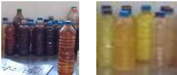
Gambar 8. Pengaruh jenis plastik pada warna bahan bakar
