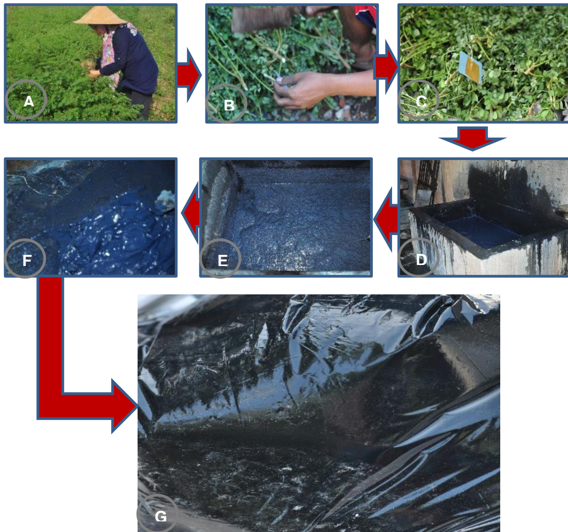
Gambar 5. Langkah pembuatan pasta indigo. A. Pemanenan daun Indigofera dari lahan, B. Dahan dan daun dicacah, C. Daun direndam dg air sampai terendam seluruhnya ditambah dengan batu diikubasi selama 24 jam, D. Air rendaman yang telah di airasi sehingga berwarna biru, E. Ekstran/pasta dibagian bawah yang telah mengendap setelah dibiarkab selama 24 jam, F. Air dibagian atas endapan dibuang sehingga meninggalkan pasta, G. Pasta dengan kadar air 70%.
